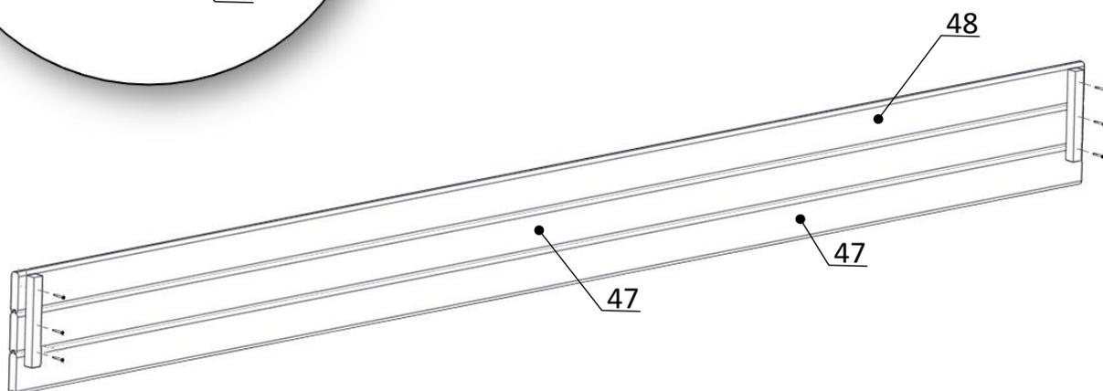
**Dwa boki: przesunięcie listwy montażowej 30mm.**
