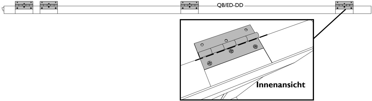
19a. **DU:** Schritt 19B, für alle Modellen mit doppelter Tür.
