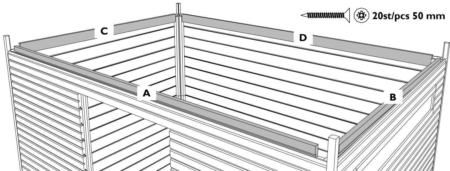
**DU:** Die Zeichnung zeigt eine Abwässerung in die linker Ecke, Spiegeln sie für eine Abwässerung in die rechter Ecke. Es kann sein das diese kein Nut haben in die lange Richtung, dies ist kein Problem.
